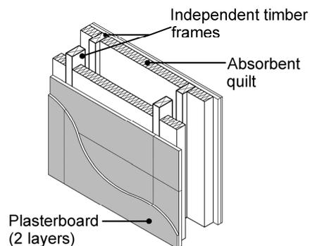
(d) **WT 4** - Timber framed walls with absorbent material
